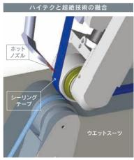
熱風溶着方式を採用。シームテーブ接着層のみに熱風(Max.700℃)を吹きつけ融解させ、ローラーの加圧によって溶着する方式。ウエットスーツ本体に熱による影響がなくまた常に同じ温度、圧力で作業できるので安定した品質を保つことができます。
