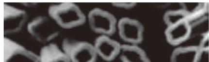
大きな空洞を持つマカロニ状の糸に、大量の空気(デッドエア)を封じ込めたハイテク繊維。中空率を極限にまで高め、優れた保温力を生む。軽量で快適なポリエステル素材
